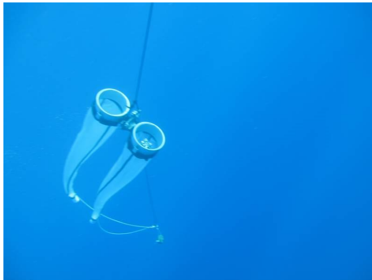
איור ד36: רשת הפלנקטון הכפולה ("Bongo") נגררת מהסירה בים העמוק. צילום: מ. צ'רניחובסקי Figure D36: A double plankton net ("Bongo") towed from the boat in deep waters. Photo: M. Chernihovsky
