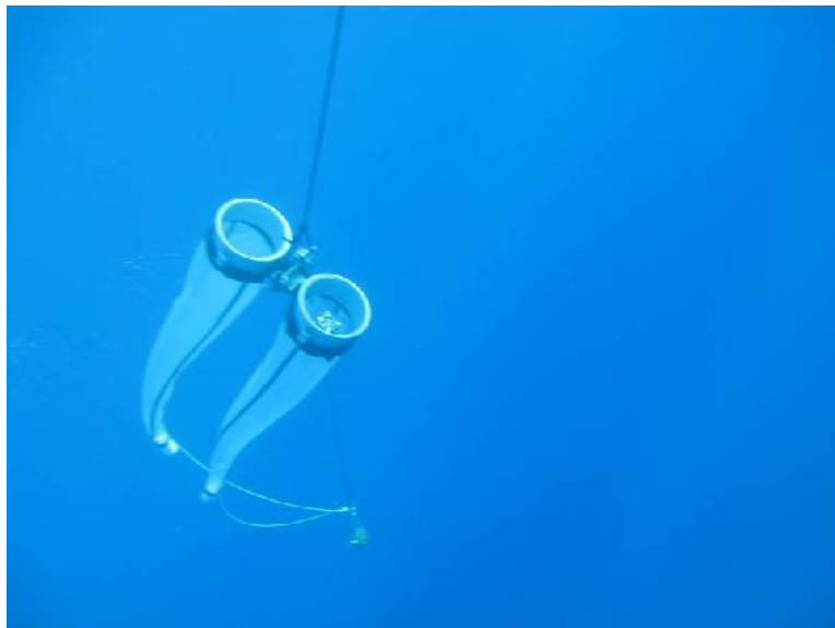
איור ד32: רשת הפלנקטון הכפולה ("Bongo") נגררת מהסירה בים העמוק. Figure D32: A double plankton net ("Bongo") towed from the boat in deep waters.
