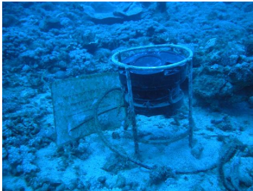
איור ה11: מכשיר ה-ADCP על קרקעית הים בעומק 44 מ', מול הקצה הדרומי של המכון הבין-אוניברסיטאי. המכשיר מחובר בכבל תקשורת וחשמל ומזין נתונים ישירות לשרת המכון.
